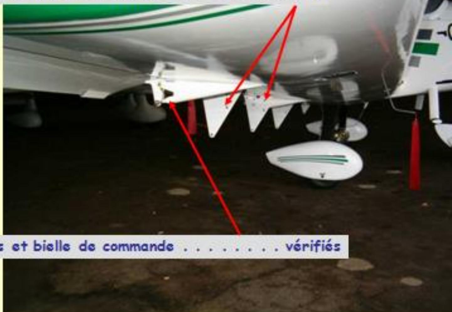
Aileron, fixations et bielle de commande . . . . . vérifiés
