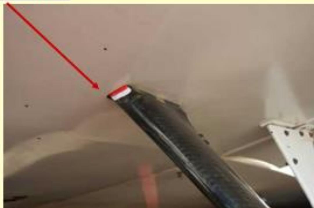
Permet de vérifier le non déplacement de la lame de train dans son logement
