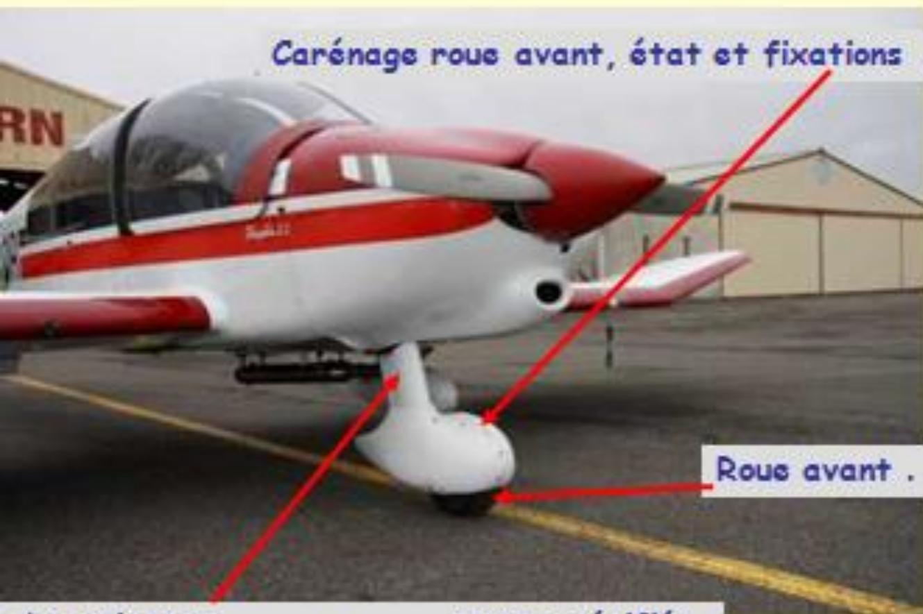
Carénage roue avant, état et fixations . . . . . vérifiés
