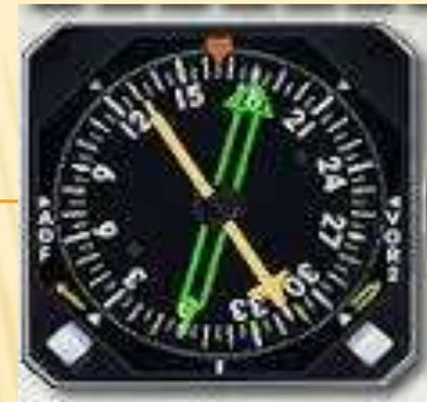
Le R.M.I. (Radio Magnetic Indicator) est un **indicateur radiocompas de relèvement.**
