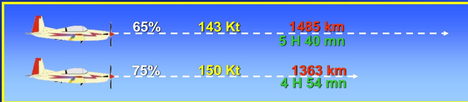
Moteur 200 Cv – 242 litres – Même niveau FL 75 – Même réglage mixture (-100°F)
