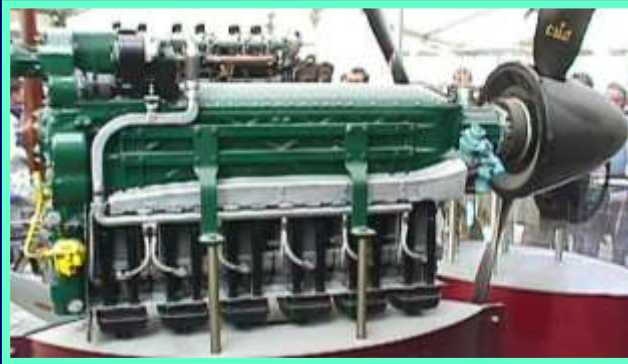
CYLINDRES EN LIGNE (normaux ou inversés)
