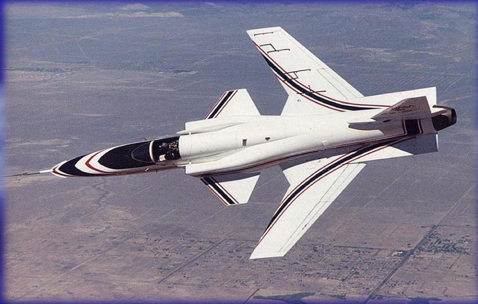
... ou trapézoïdale à « **flèche inverse** » comme pour le X 29.
