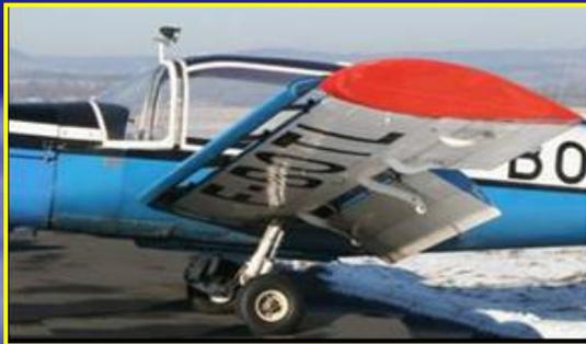
A vitesse élevée les becs sont plaqués contre le bord d'attaque de l'aile et se déploient vers l'avant automatiquement grâce à la dépression locale à incidence élevée. Ces becs sont montés notamment sur les Morane-Saulnier Rallye.
