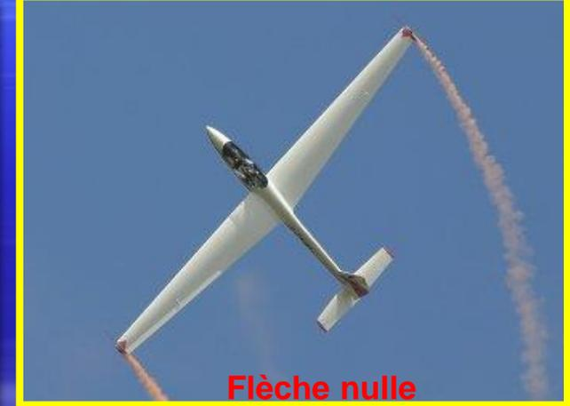
La flèche d'une voilure est exprimée en degrés. Elle peut être positive (vers l'arrière), négative ou nulle.
