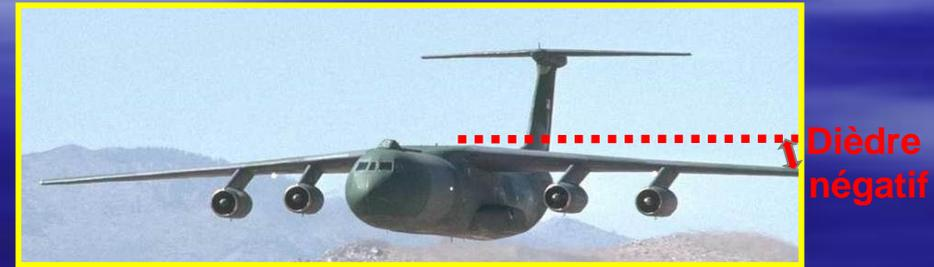
Le dièdre d'une voilure peut être exprimée en degrés ou en mètres mesurés en bout d'aile.
